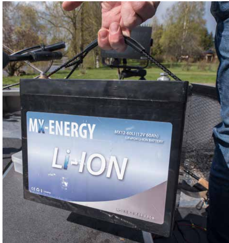
Jani Ollikaisen Mastervolt-litiumakku painaa vain murto-osan lyijy-akusta ja tarjoaa yliveraisen suorituskyvyn. Kuva Antti Zetterberg.
