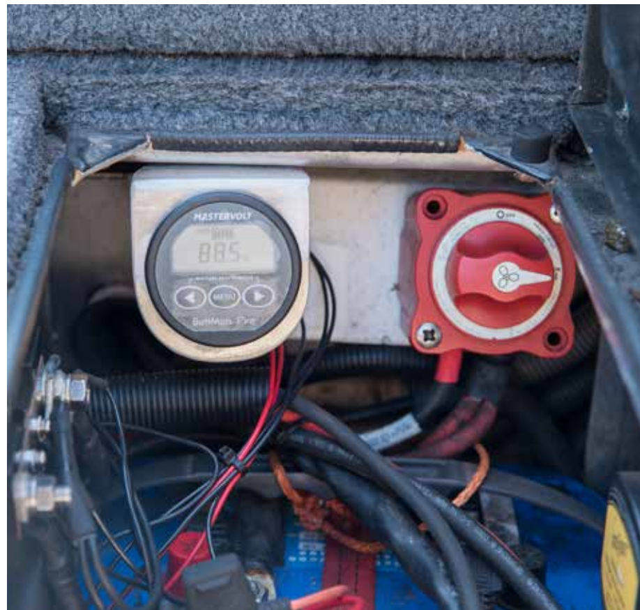
Kalastusopas Kalle Paavola vaihtoi veneensä akuston litiumakkuihin sekä Mastervoltin valvontajärjestelmään. Kevyempi vene kulkee vähemmällä kulutuksella ja hyötykuormaa voidaan ottaa lisää. Kuva Antti Zetterberg.
