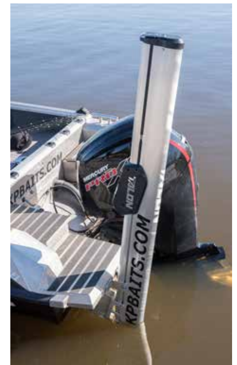
Kalastusopas Kalle Paavolan Minn Kota Talon -matalan veden ankkuri. Talonin terävä ”ankkurivarsi” toimii teleskooppiperiatteella sähköisesti. Kuva Antti Zetterberg.
